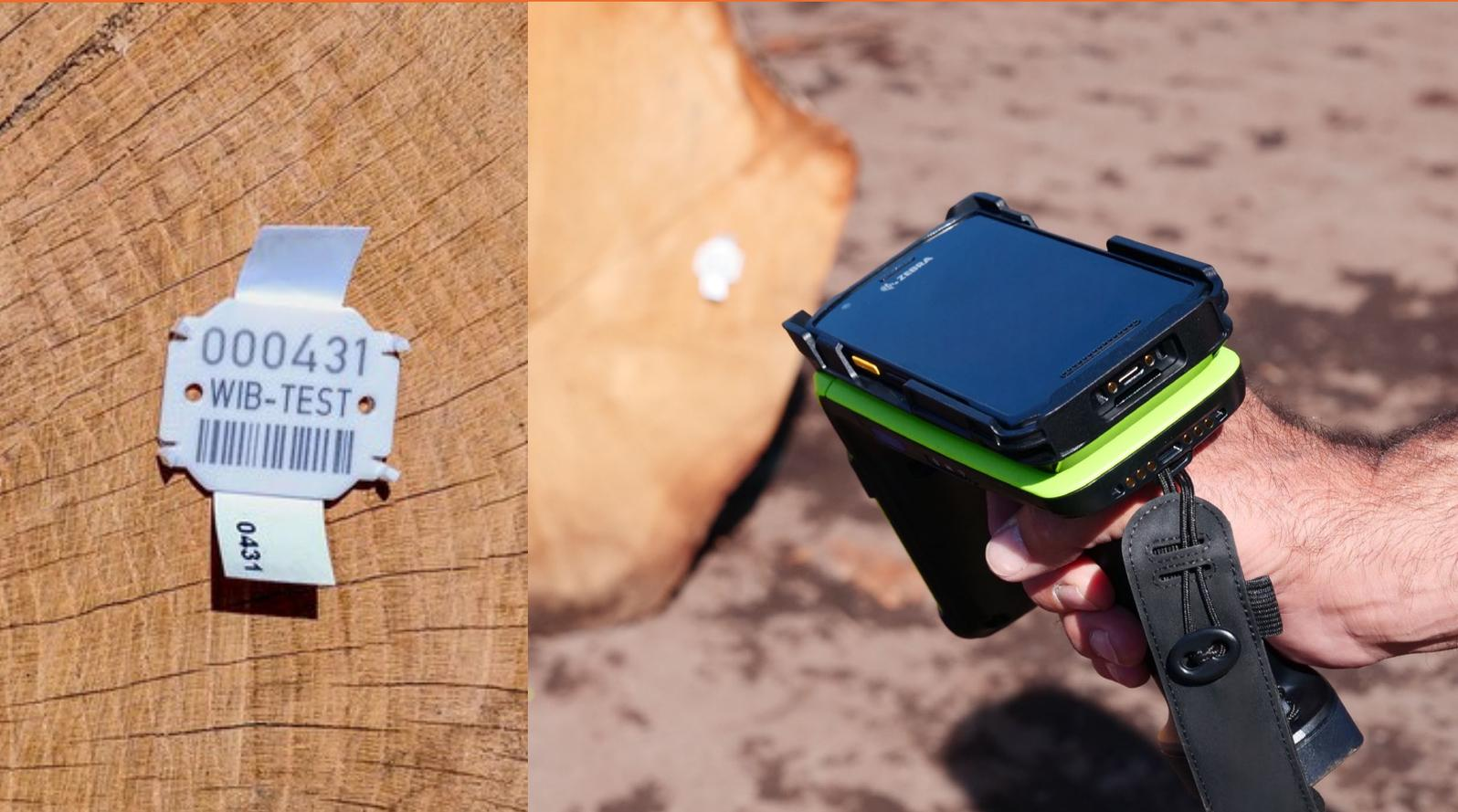
Wertvolle Rundholzstämme können besonders sicher mit RFID-Tags gekennzeichnet werden und sind dann sehr schnell, fehlerfrei und komplett vollständig lesbar – sogar bei extremen Witterungsbedingungen wie Schnee. Sie besitzen volle lückenlose Kontrolle über Ihre Holzanfuhr und -lagerung.
